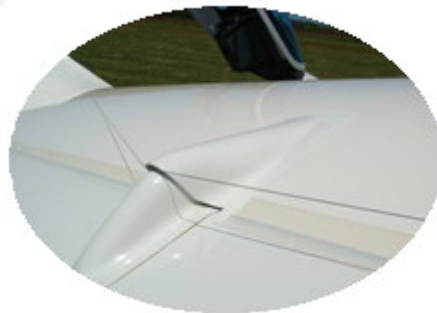
ABBILDUNG 12: RÜCKHOLSEIL AN ANLANKHUTZE HÄNGEN GEBLIEBEN
