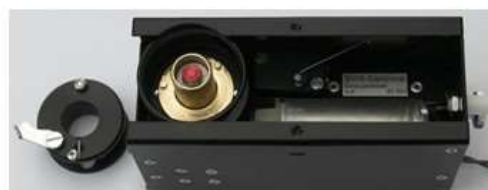
ABBILDUNG 7 RUTSCHKUPPLUNG; MIT DER SCHRAUBE AUF DER SEILTROMMEL (IM BILD ROT MARKIERT) KANN DIE RUTSCHKUPPLUNG EINGESTELLT WERDEN
