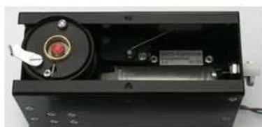
ABBILDUNG 7 RUTSCHKUPPLUNG; MIT DER SCHRAUBE AUF DER SEILTROMMEL (IM BILD ROT MARKIERT) KANN DIE RUTSCHKUPPLUNG EINGESTELLT WERDEN
