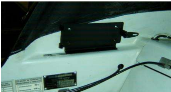
ABBILDUNG 17 EINBAU DER E-MOTORBOX MITHILFE DES MONTAGESCHLITTENS AN DER BORDWAND
