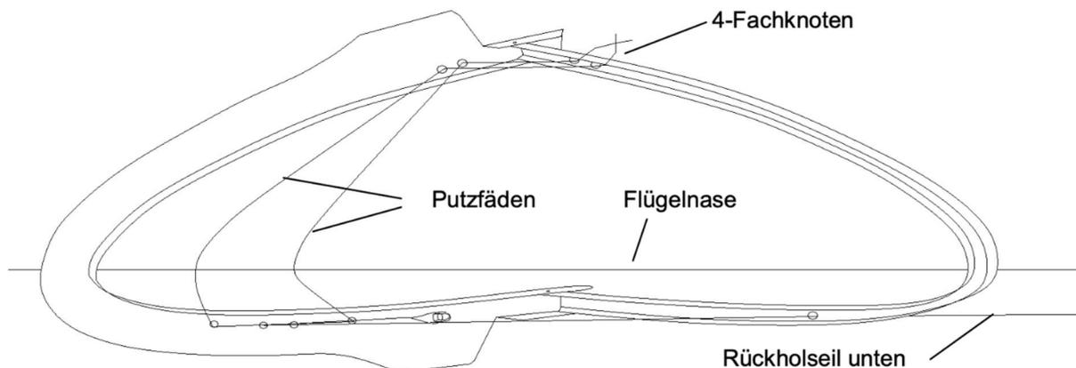
Der Abstand zwischen breitem Antriebsflügel und Flügelnahe soll bei aufgesetztem Mückenputzer, in der Nähe der Flügelnahe, ca. 5 mm betragen.
