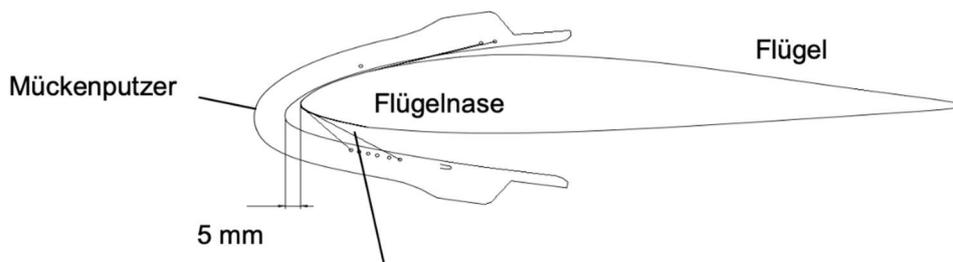
Putzfäden aus Fischer-Nylon 0,2mm im Durchmesser, mit einer Festigkeit von ca. 4kg
